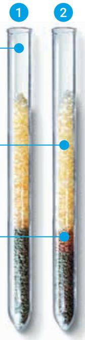
Пробирка, содержащая индикатор фирмы-конкурента (желтый) и индикатор очистки газов (зеленый) в начале эксперимента.
