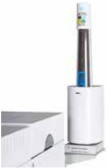
Рис. 4. Уникальный датчик очистки газов на модели 8890/8860 автоматически осуществляет мониторинг химических показателей, и при насыщении фильтра светодиод меняет цвет с зеленого на желтый.
